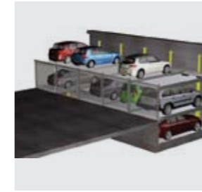
La piattaforma dell'auto azzurra si solleva. Viene prenotata l'auto bianca.
