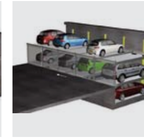
Le piattaforme del livello intermedio traslano lasciando il posto vuoto jolly sotto l'auto bianca.
